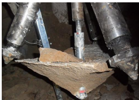
Rys. 8. Wyrwany stożek skalny [4]
