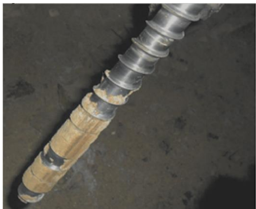
Rys. 6. Wrywanie (wyciąganie) kotew HMS-MX
