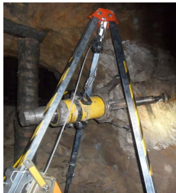
Rys. 4. Urządzenie drażące wyrobisko ratunkowe [4]
